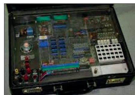
Cvičné panely TEMS 80-03 firmy TESLA IMA Pardubice s procesory Intel 8080.
